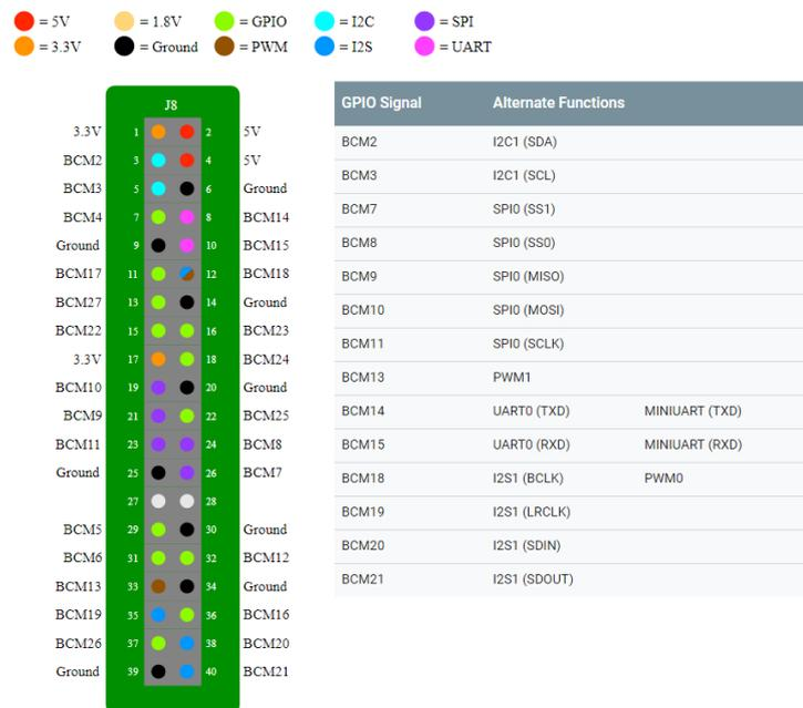
Figura 2 - Diagramma di piedinatura della Raspberry PI 3 Model B
