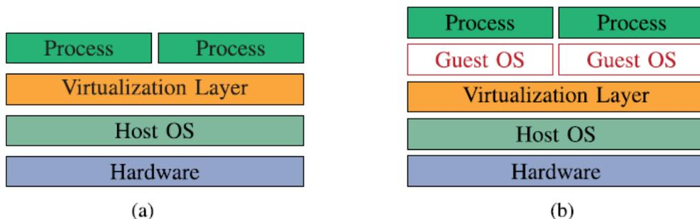
Figura 3.1: Confronto tra container e hypervisor - (a) Container, (b) Macchina virtuale
