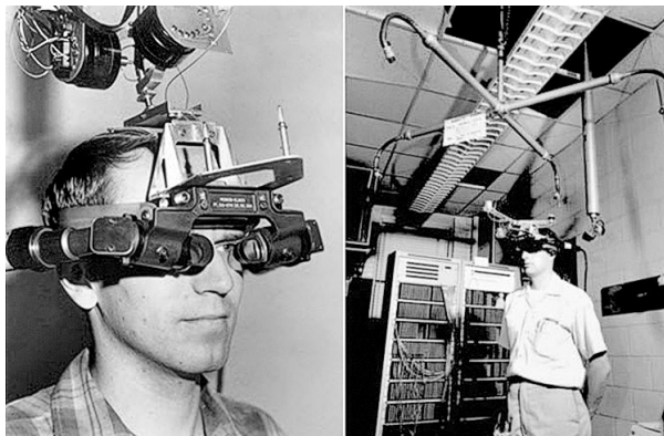
Figura 2.3: A sinistra: Sutherland con indosso il suo visore; a destra: la Spada di Damocle con il suo supporto
