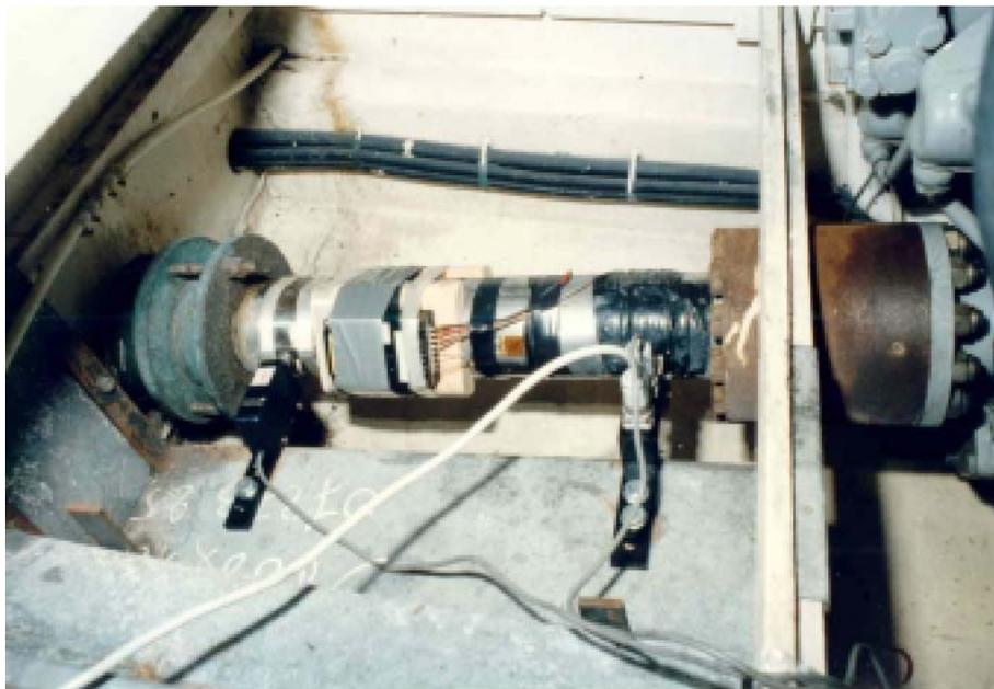
Fig. 4 – Installazione di un sistema di misura della potenza
