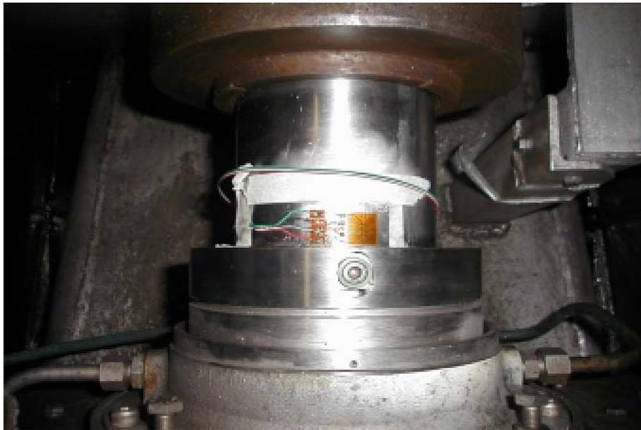
Figura 5 – Installazione di un estensimetro in spazi ristretti
