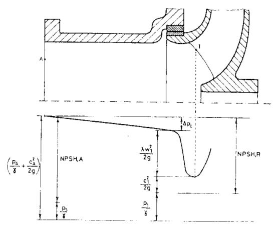
Trasformazioni del contenuto energetico del fluido tra la flangia d'ingresso del corpo pompa e l'occhio della girante (da: R. Della Volpe: *Macchine*, Liguori ed.)
