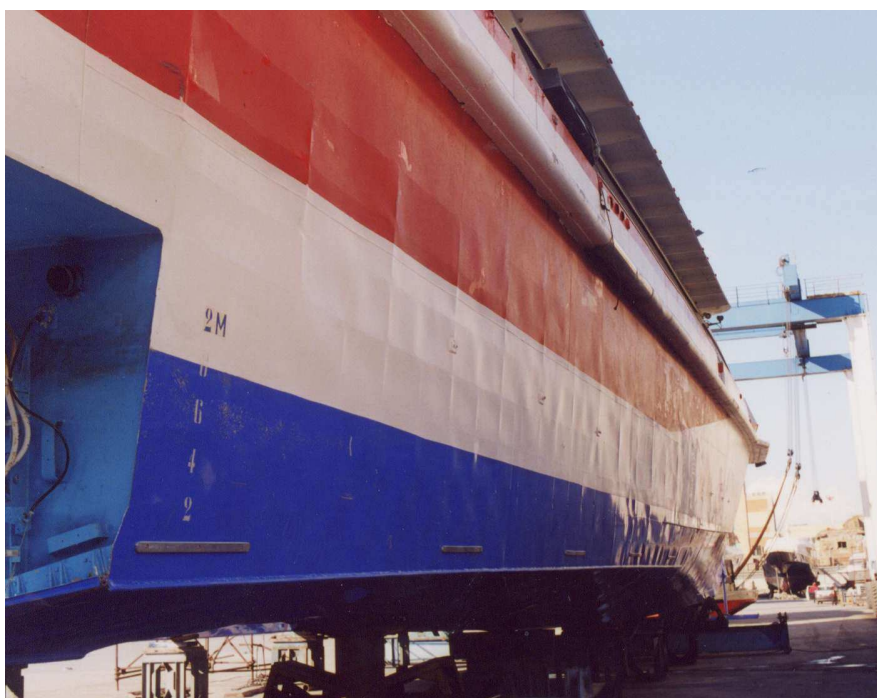
Figura 3 – anodi sacrificali di zinco sulla carena di un catamarano
