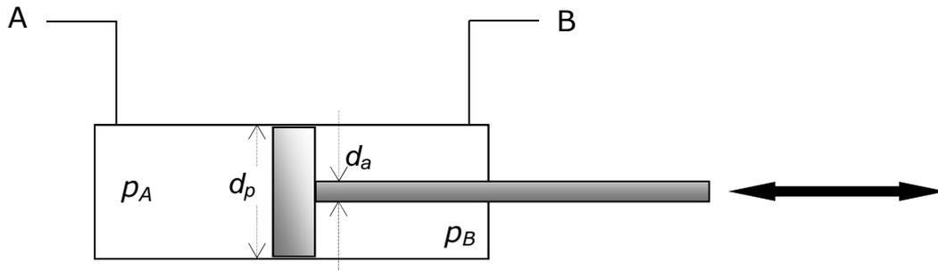
Le attuazioni lineari vengono realizzate con l'utilizzo di pistoni spinti dalla forza che l'olio in pressione esercita sulla *corona* (o *cielo*) o sulla zona inferiore (o *base*); tali meccanismi vengono detti *cilindri oleodinamici* (o *pistoni oleodinamici*). Anche alcune attuazioni non lineari sono realizzate con pistoni e con l'ausilio di meccanismi che generano rotazione.
