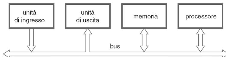
Figura 1.3 Calcolatore strutturato intorno a un solo bus.
