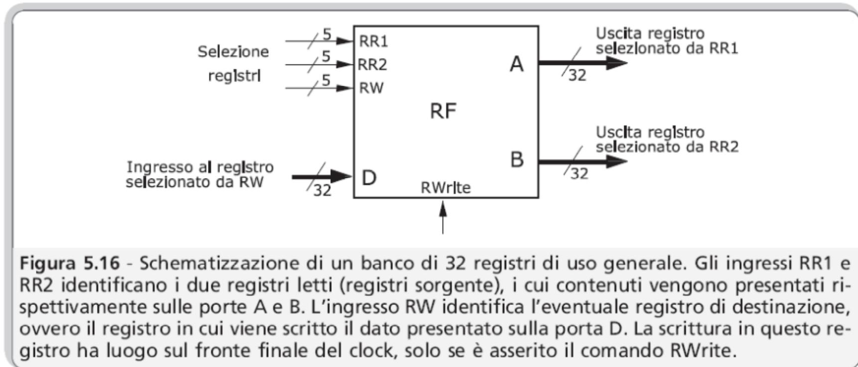
**Figura 5.16** - Schematizzazione di un banco di 32 registri di uso generale. Gli ingressi RR1 e RR2 identificano i due registri letti (registri sorgente), i cui contenuti vengono presentati rispettivamente sulle porte A e B. L'ingresso RW identifica l'eventuale registro di destinazione, ovvero il registro in cui viene scritto il dato presentato sulla porta D. La scrittura in questo registro ha luogo sul fronte finale del clock, solo se è asserito il comando RWrite.
