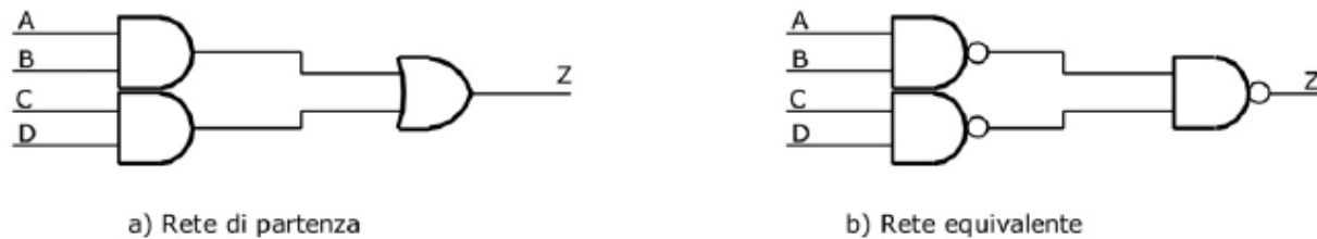
Figura 3.16 - Passaggio da rete SP a rete NAND. In questo caso, il passaggio richiede solo la sostituzione di porte AND e OR con porte NAND.
