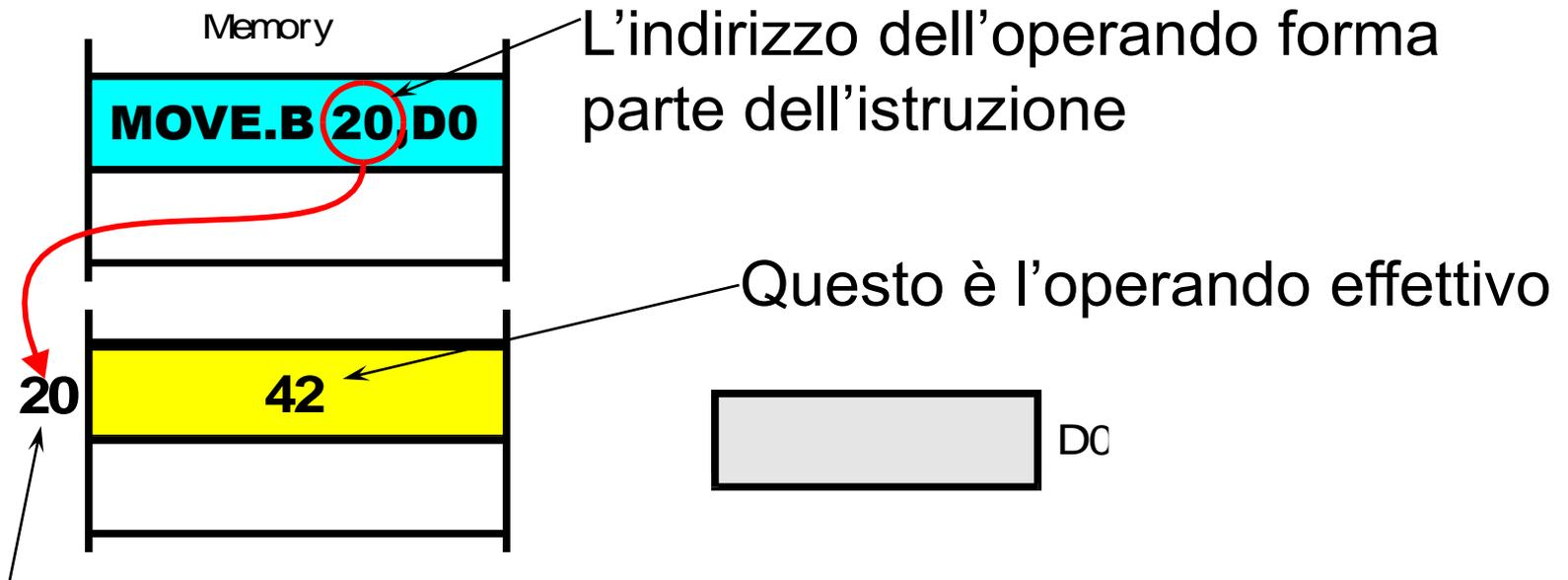
Una volta che la CPU ha letto l'indirizzo dell'operando dall'istruzione, la CPU accede all'operando effettivo
