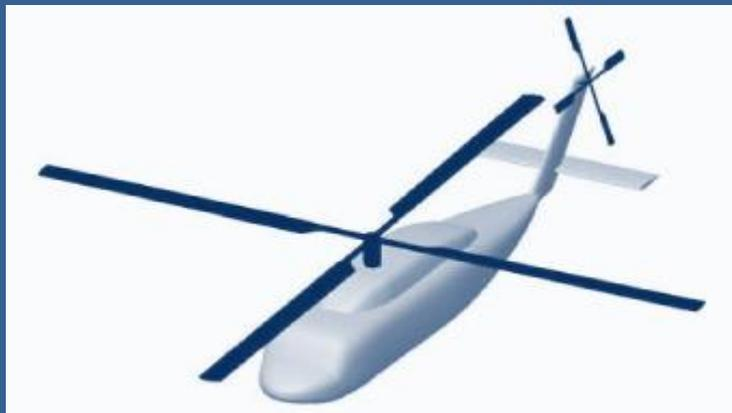
Configurazione elicottero (convenzionale) con rotore principale e rotore anticoppia di coda
