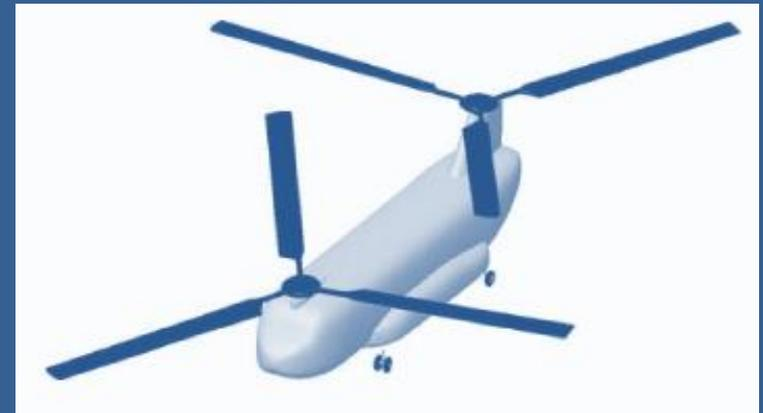
Configurazione elicottero con due rotori controrotanti in tandem
