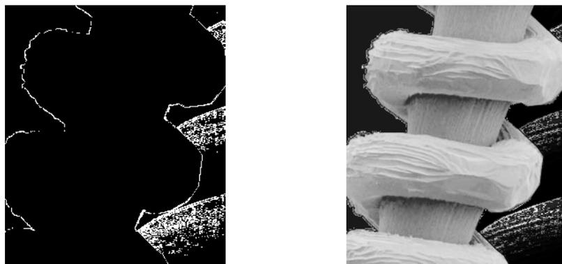
Figura 20: Immagine che indica i pixel da enfatizzare e risultato dell'elaborazione.
