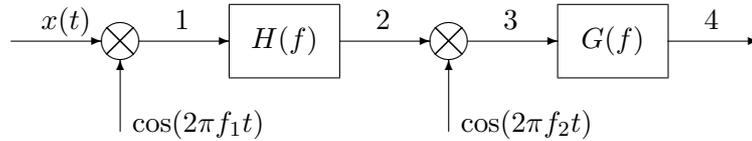
Nel sistema di figura,  $H(f)$  è un filtro ideale passa alto con banda  $B = 20\text{kHz}$ ,  $G(f)$  è un filtro ideale passa basso con banda  $B = 20\text{kHz}$ ,  $f_1 = 20\text{ kHz}$ ,  $f_2 = 25\text{ kHz}$ .
