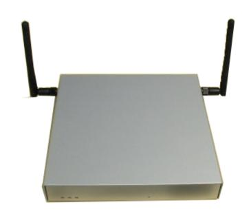
**NOX** Box 500Mhz Geode CPU **256 MB RAM 2GB Flash**
